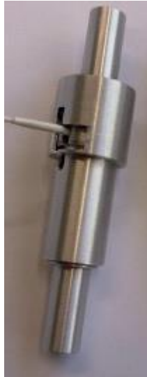
Figura 1.8 Célula de carga montada en el sistema de aislamiento de momento flector
