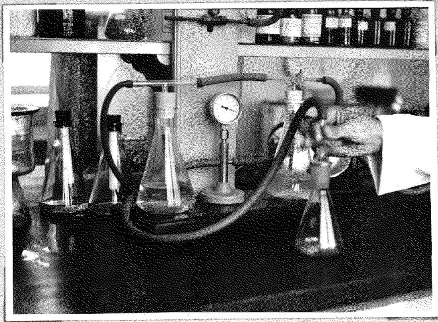
Matraz, provisto de llave y tapon esmerilado, donde se procede a cambiar el aire, por la mezcla de  $\text{CO}_2$  y  $\text{N}_2$ . Una vez hecho esto, se agita el matraz con los testiculos y el liquido elegido, durante quince minutos
