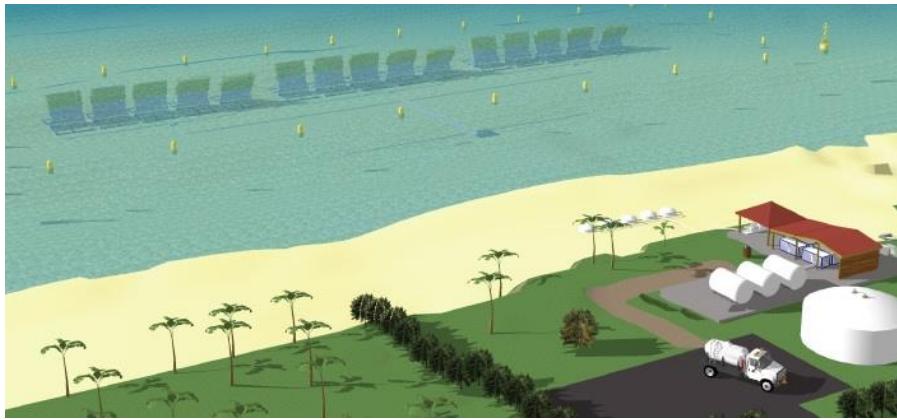
Figura 3-13. Esquema del proyecto Wave 2 O TM operando con 15 WEC: [13].
