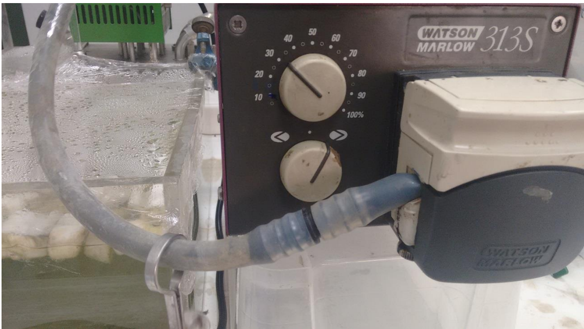
Figura 31: Imagen de la unión entre secciones en la bomba peristáltica utilizada en la recirculación (Fotografía: Antonio José Alonso).
