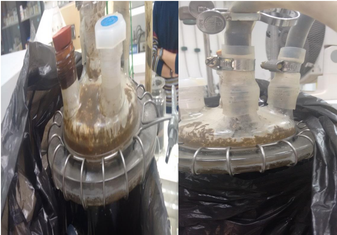
Figura 21: Imagen de las aberturas superiores en la tapa del digestor. (Fotografía: Antonio José Alonso).
