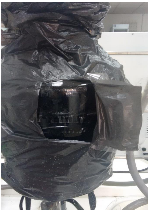
Figura 33: Imagen de las ventanas realizadas en el plástico que cubre el digestor para ver su estado (Fotografía: Antonio José Alonso).
