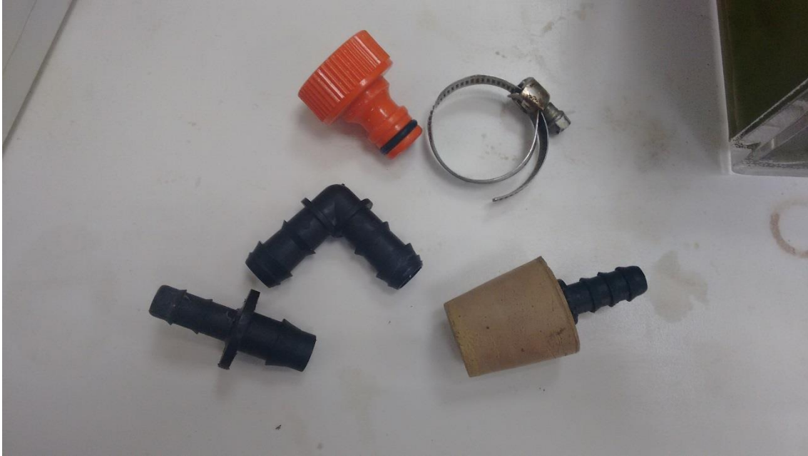
Figura 168: Imagen de las conexiones y enlaces empleados en el montaje del digester anaerobio. (Fotografía: Antonio José Alonso).
