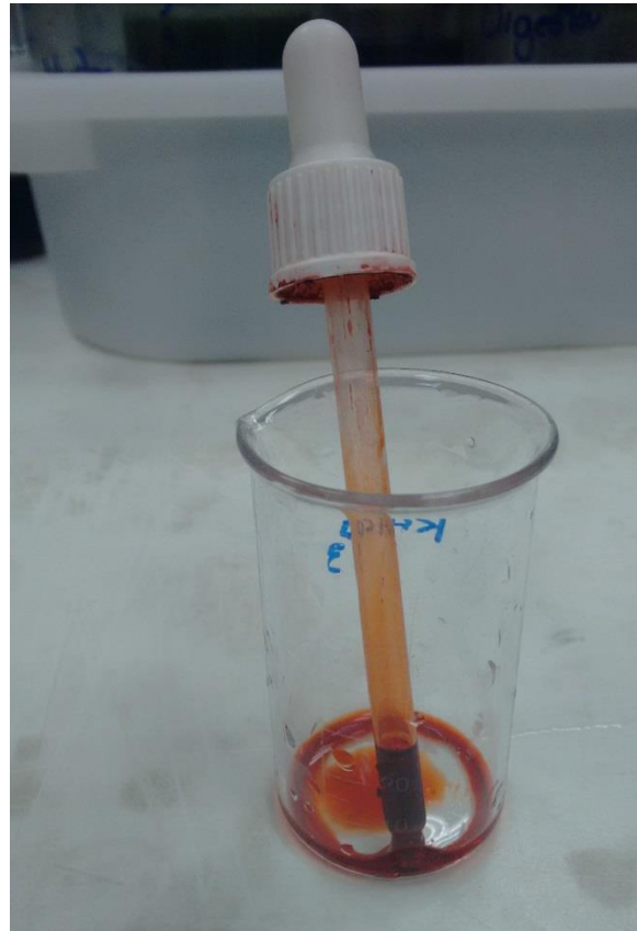
Figura 38: Imagen del indicador a utilizar en la valoración para la determinación de la DQO. (Fotografía: Antonio José Alonso).
