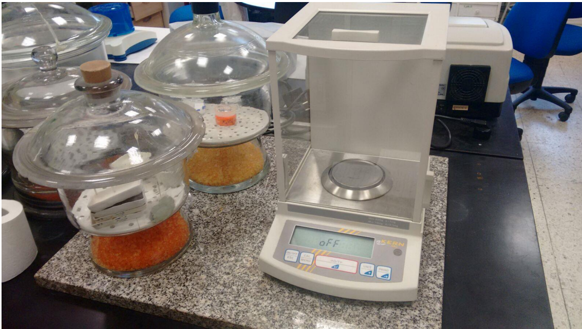
Figura 42: Imagen de la campana de enfriamiento y la balanza de precisión (Fotografía: Antonio José Alonso).
