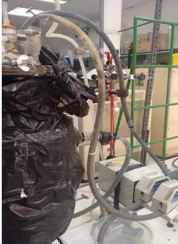
Figura 23: Imagen de la instalación de alimentación y extracción de muestra utilizada en el proceso (Fotografía: Antonio José Alonso).
