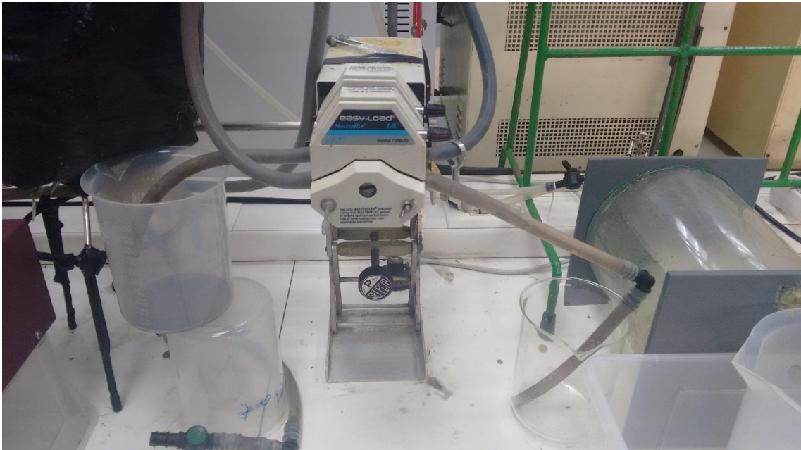
Figura 22: Imagen de la bomba peristáltica utilizada en el proceso (Fotografía: Antonio José Alonso).
