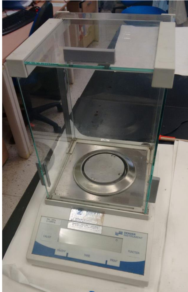
Figura 48: Balanza de precisión utilizada para realizar las pesadas en los análisis. (Fotografía: Antonio José Alonso).
