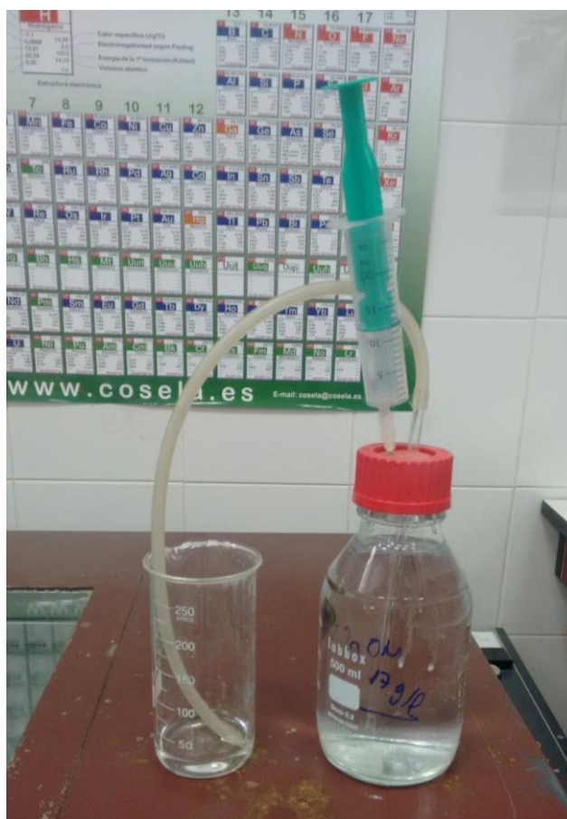
Figura 46: Imagen del baño de NaOH utilizado para medir la composición del gas generado (Fotografía: Antonio José Alonso).
