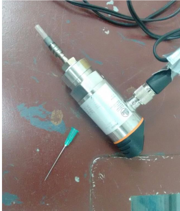
Figura 43: Imagen del equipo de medida de la presión (Fotografía: Antonio José Alonso).
