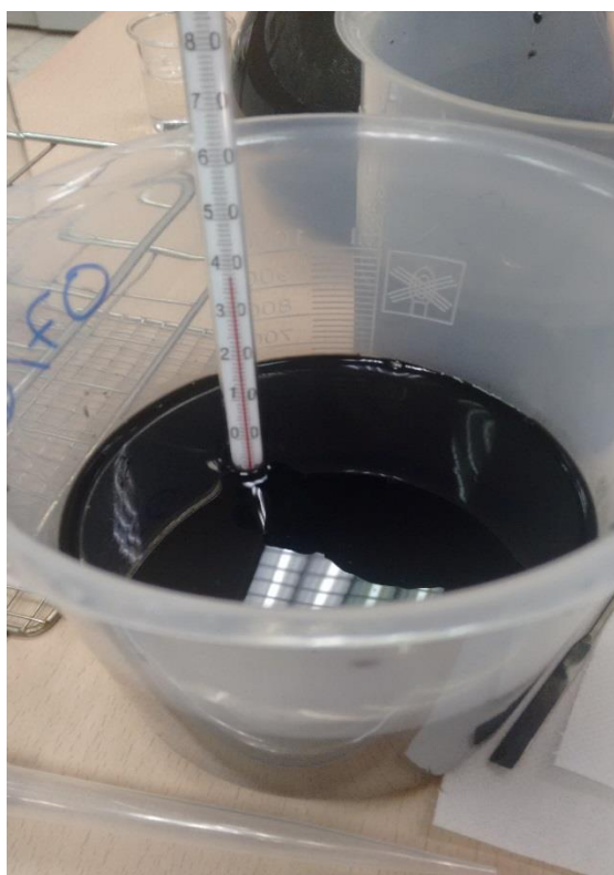
Figura 166: Imagen de la medida de temperatura a la muestra extraída del digestor (Fotografía: Antonio José Alonso).
