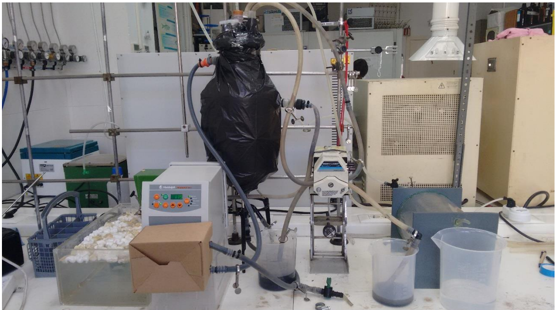
Figura 36: Imagen del digester cubierto por el plástico protector (Fotografía: Antonio José Alonso).
