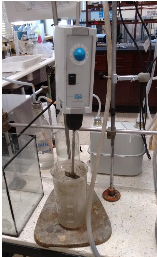
Figura 24: Imagen de la varilla agitadora eléctrica utilizada para homogeneizar la mezcla. (Fotografía: Antonio José Alonso).
