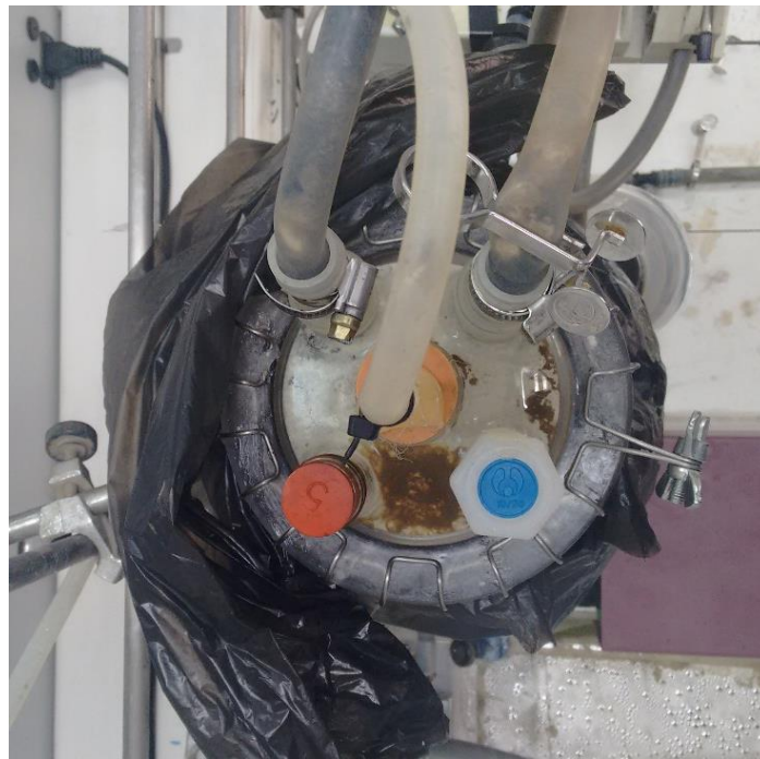
Figura 19: Imagen superior de la tapadera del digestor anaerobio utilizado en el proceso. (Fotografía: Antonio José Alonso).
