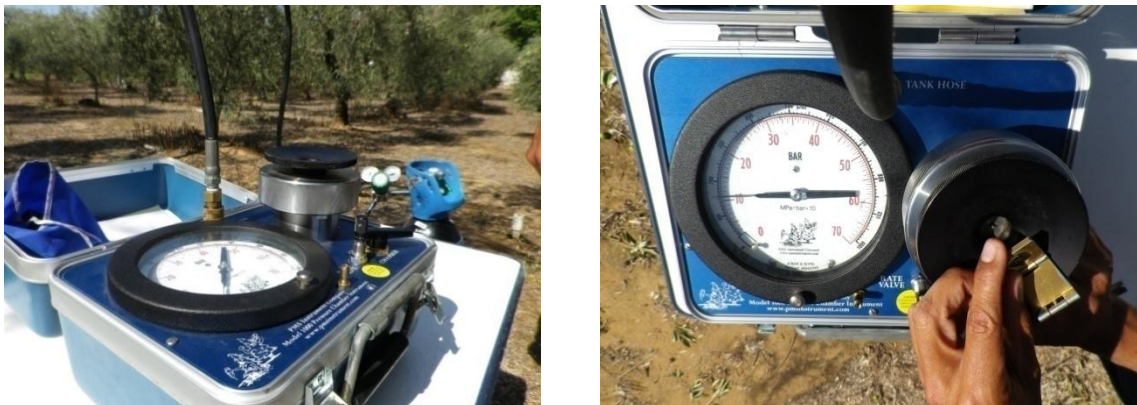
Foto 2. Izquierda: cámara de presión. Derecha: detalle de medida del potencial hídrico.
