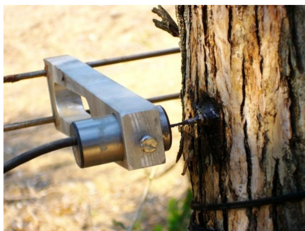
Foto 4: Bobina del dendrómetro y aguja colocado en un árbol experimental. El dendrómetro está sujeto por el portasensor que abraza el tronco. La aguja está pegada al tronco por una sustancia adherente inocua para el árbol.
