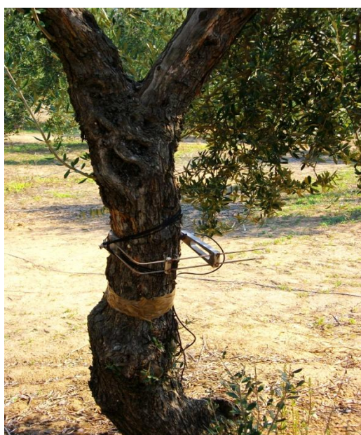
Foto 5: Portasensor colocado en un árbol experimental.
