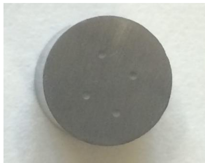
Figura 3.27. Ejemplo de indentaciones realizadas sobre una probeta para medir la dureza en caliente.
