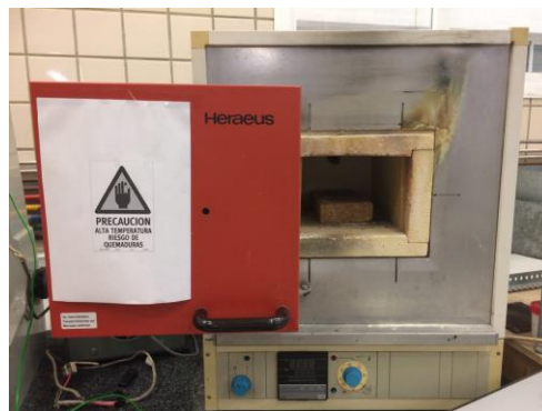
Figura 3.25. Horno de mufla HERAEUS utilizado para el tratamiento térmico.
