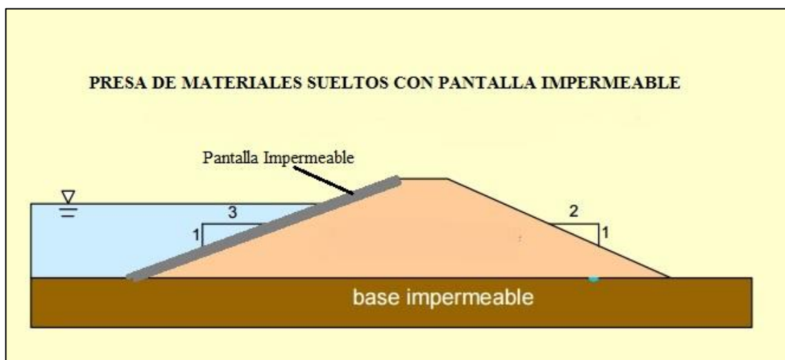
Ilustración 14: Esquema presa de materiales sueltos con pantalla impermeable
