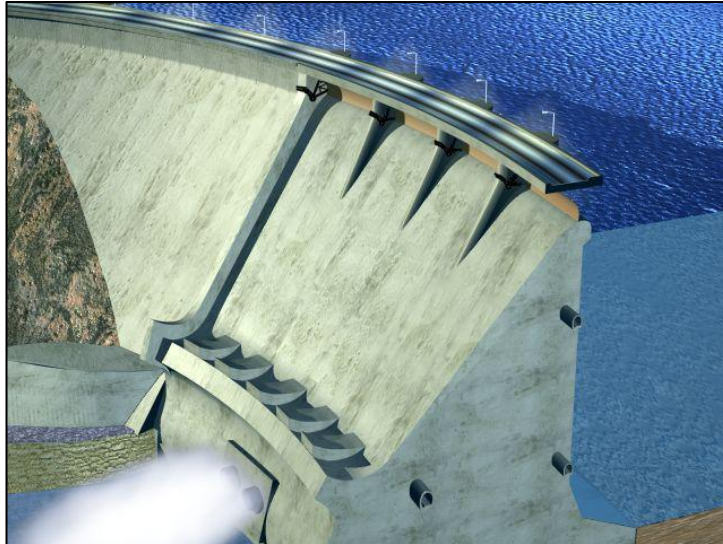
Ilustración 5: Presa de arco gravedad.
