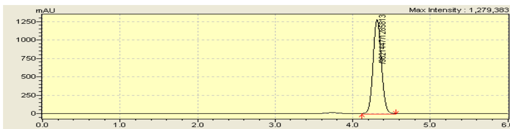
Figura 9. Cromatograma de vitamina C. En el cromatograma se observa la absorbancia en mAU y el tiempo en minutos en el que se detecta el pico de ácido ascórbico.
