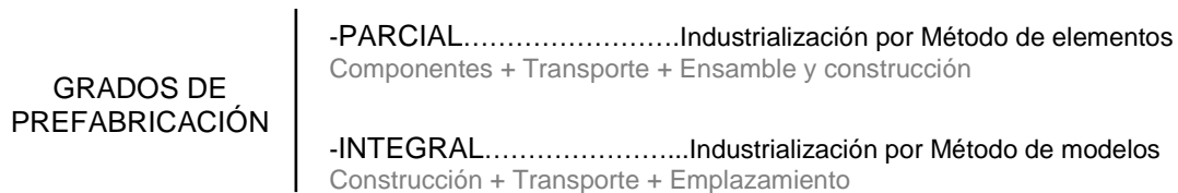
Fig. 2 “Grados de prefabricación”. Fuente: Águila, 2006 [3].
