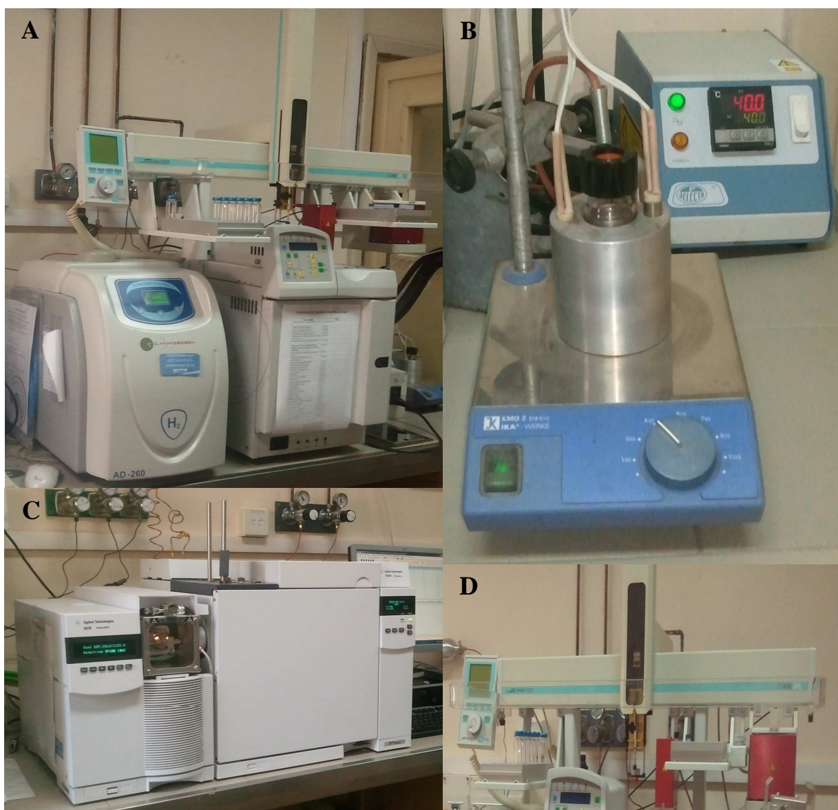
Figura 19. (A) Cromatógrafo de gases Varian 3900, equipado con inyector Combi PAL (B) dispositivo para SMPE manual, (C) cromatógrafo de gases 7820A con MS 5975 Agilent, y (D) automuestreador para SPME Combi PAL.
