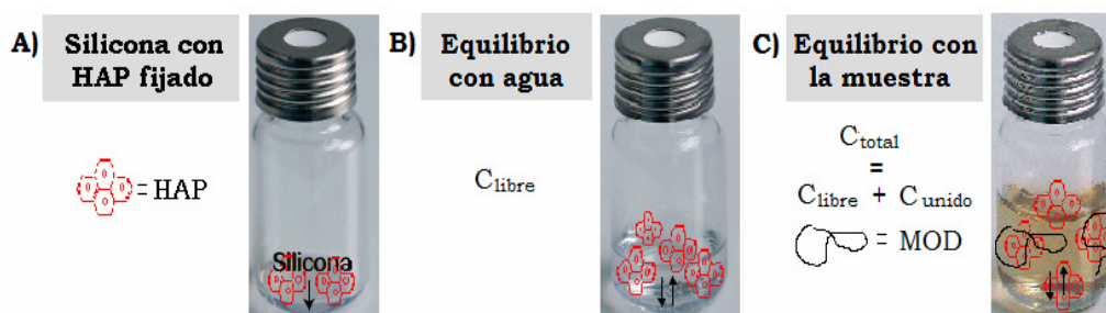
Figura I. 9.- Fundamento de la técnica de dopaje pasivo: A) Los analitos disueltos en metanol se fijan en la silicona formada por polidimetilsiloxano (PDMS) en menos de una hora, B) equilibrio alcanzado con agua donde se controla la concentración libre disuelta de los analitos y C) equilibrio alcanzado con la muestra donde se mide la concentración total del analito (libre y unida a la materia orgánica disuelta, MOD) (Modificación del esquema de Birch y col, 2010).
