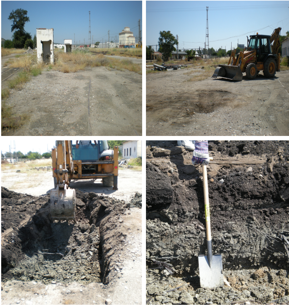
Figura III. 1.- Emplazamiento contaminado con creosota. Fotos de la zona y del muestreo de suelo.
