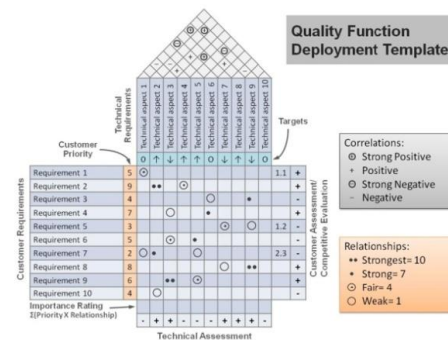
Figura 6. Diagrama Funcional de Análisis e interrelaciones de la función de calidad (QFD) aplicado al ámbito urbano. Fuente: The Ecological Urban Interaction Matrix (MIEU).
