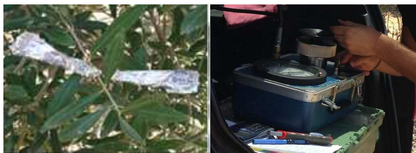
Foto 4; Izquierda: Hojas envueltas en papel de aluminio antes de la medición. Derecha: medida del potencial hídrico con la cámara de presión
