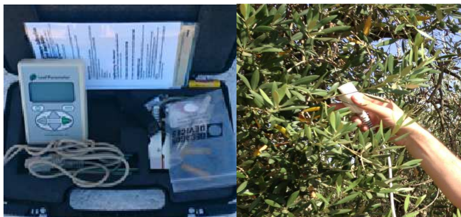
Foto 5; Izquierda: Porómetro y útiles para medir la conductancia estomática. Derecha: medida de la conductancia estomática mediante la pinza del porómetro
