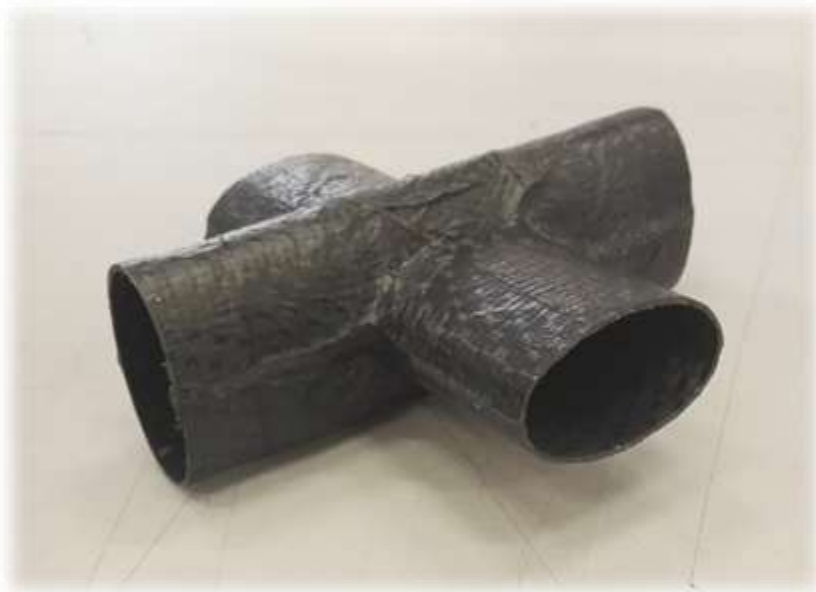
Ilustración 3 – Logro de ACES, unión de tubos de Fibra de Carbono.
