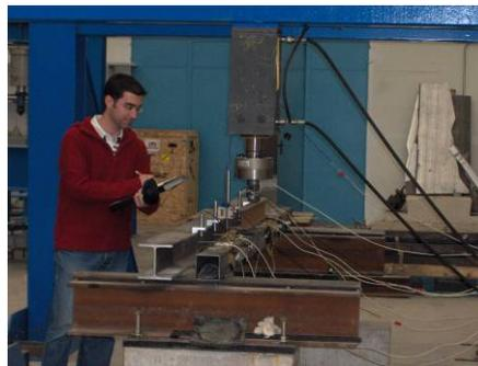
*Fig.5. Ensayo de flexión de viga metálica.*
