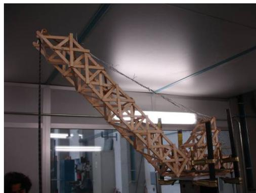
*Fig. 2. Estructura de madera tipo grúa realizada por un grupo de alumnos para elevar una carga.*
