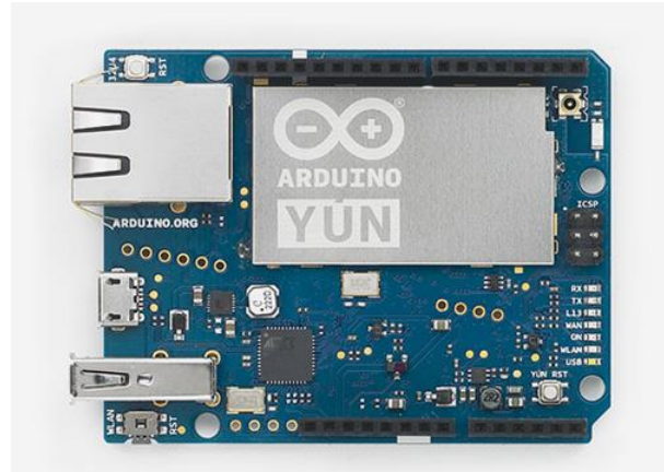
Ilustración 15: Placa Arduino Yún
