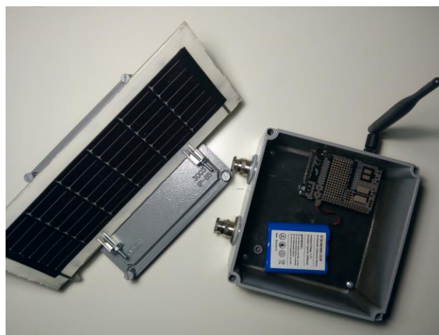
Ilustración 37: Montaje de elementos de un nodo
