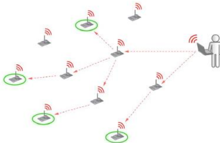
Ilustración 58: Comunicación multicast en una red multisalto
