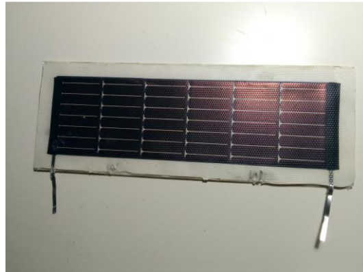
Ilustración 36: Placa fotovoltaica de 7,2V
