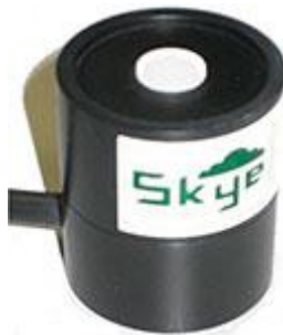
Ilustración 35: Sensor de irradiancia SP1110
