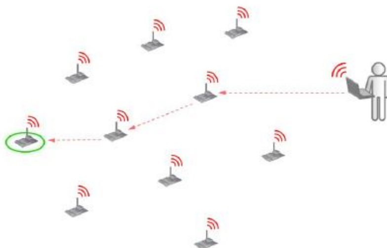
Ilustración 57: Comunicación unicast en una red multisalto
