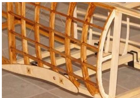
Ilustración 107. Unión entre montantes con listones y costillas y estructura del fuselaje de réplica.
