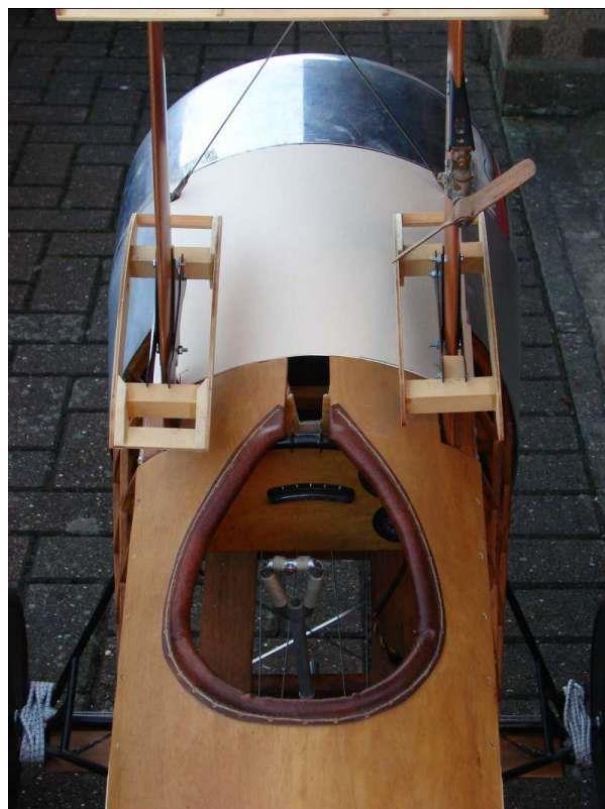
Ilustración 112. Uniones entre montantes y listones de réplica del Sopwith (II).
