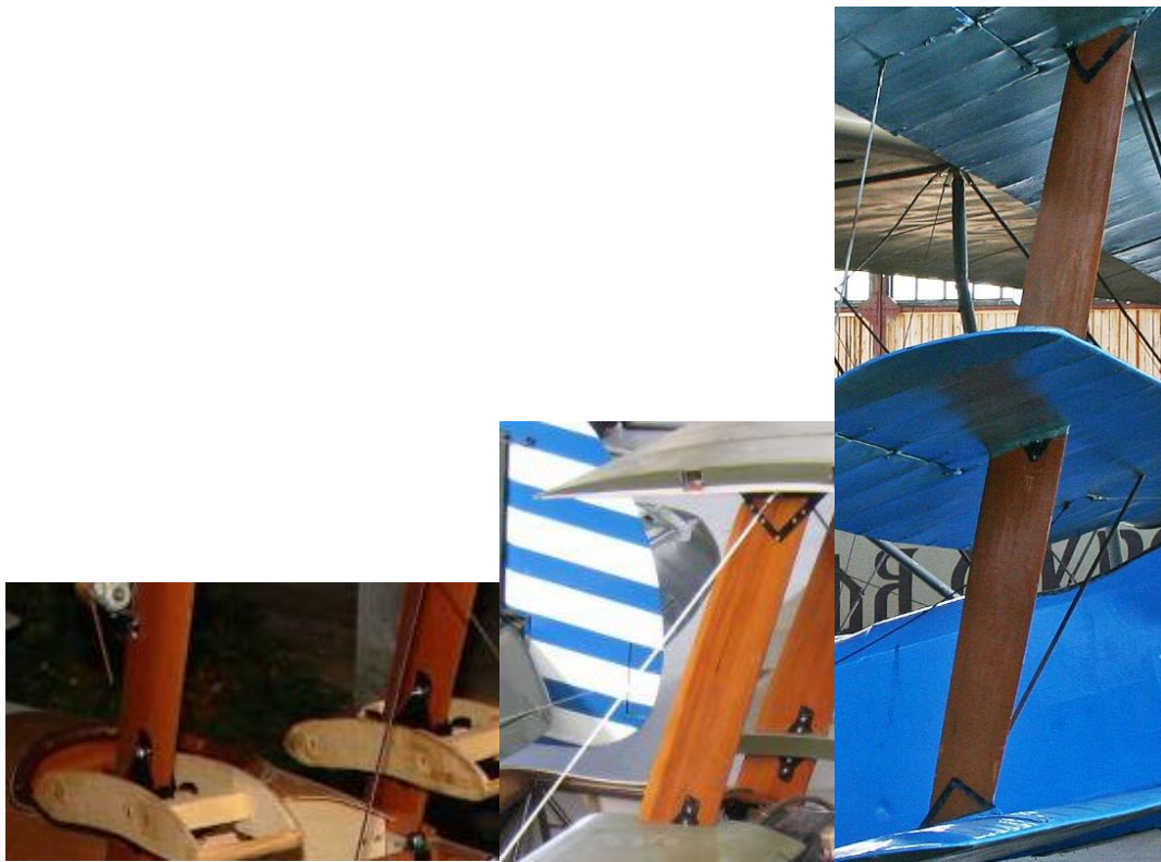
Ilustración 111. Uniones entre montantes y listones de réplica del Sopwith (I).
