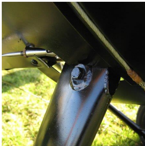
Ilustración 105. Unión de tren de aterrizaje con estructura de fuselaje de réplica de Sopwith.
