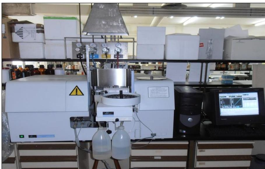
**Figura 2.** Espectrofotómetro de absorción atómica usado.
