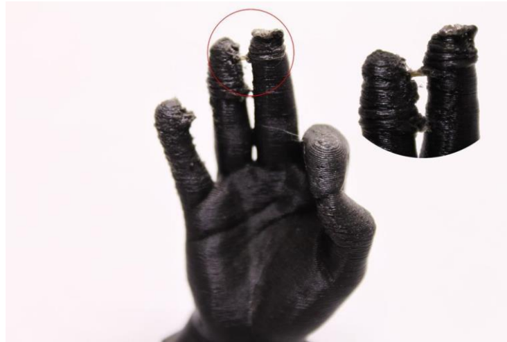
Figura 4-20. Deformaciones por sobrecalentamiento.
