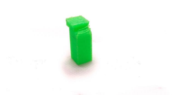
Figura 4-21. Deslizamiento de capas
