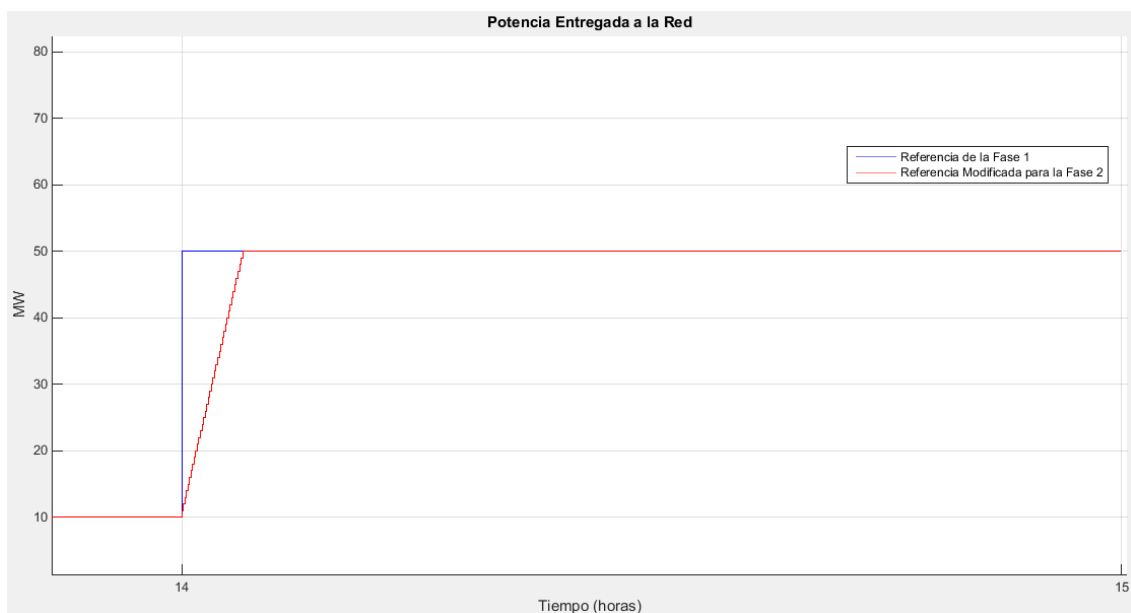
Figura 4.6. Referencia Modificada cumpliendo el límite de Gradiente de Carga
