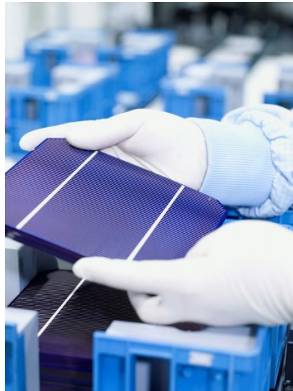
Figura 2.1. Célula Fotovoltaica Monocristalina durante su fabricación
