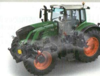
Fendt ofrece mayor potencia y eficiencia con el sistema VarioGrip para la regulación de la presión de los neumáticos. El sistema permite que la presión del neumático se regule durante la conducción. Sus ventajas:
