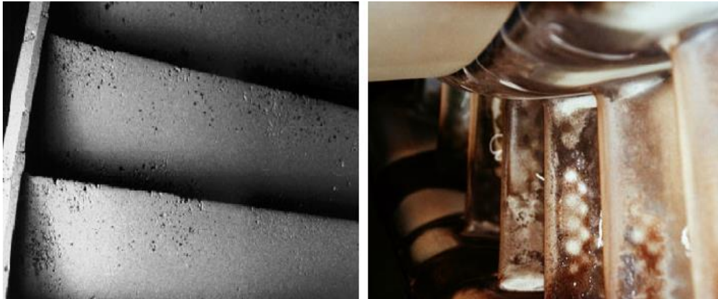
Figura 3. Corrosión fría (izquierda) y corrosión caliente (derecha). Cortesía de NC Consulting.
