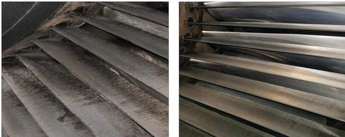
Figura 2. Misma corona de álabes de rotor con grado de ensuciamiento distinto.
