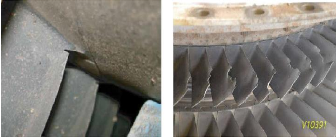
Figura 1. Erosión en corona de álabes [3]
