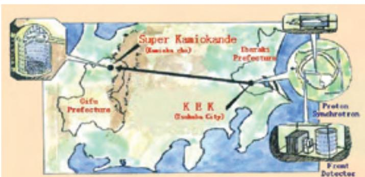
**Figura 9.** Esquema del experimento K2K en Japón. En él se envía un haz de neutrinos muónicos desde un acelerador, donde son producidos, al detector SuperKamiokande, situado a 250 Km de distancia. Este experimento está actualmente en marcha.
