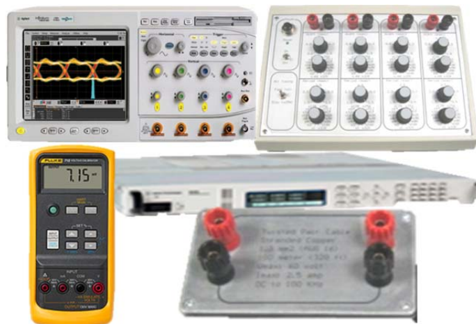
Figura 1: Osciloscopio, calibrador de lazo, generador de pulsos, fuente de alimentación y simulador de 100 metros de cable.
