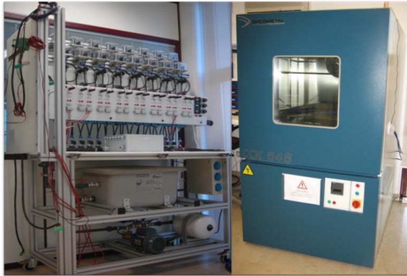
Figura 2: Banco de electroválvulas y cámara climática
