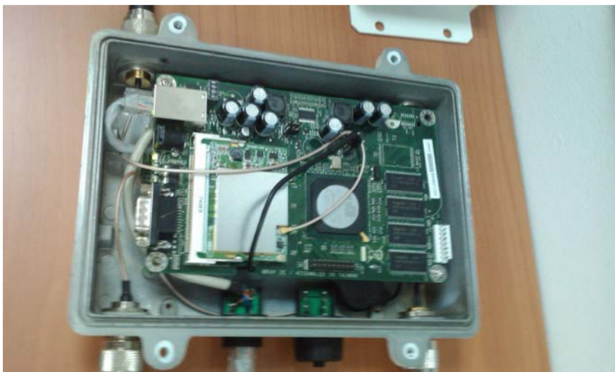
Figura 4. Ensamblaje en una caja todo tiempo para su instalación a la intemperie.
