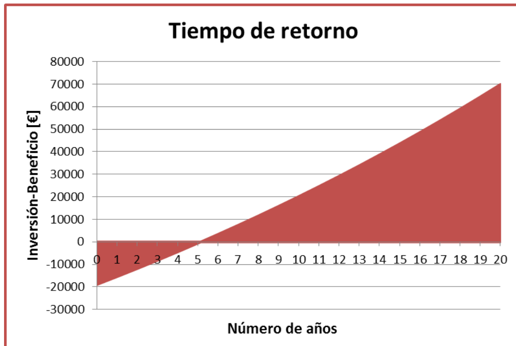
Figura 6.5: Tiempo de retorno de la inversión teniendo en cuenta averías, reparaciones y aumento del coste de la electricidad
