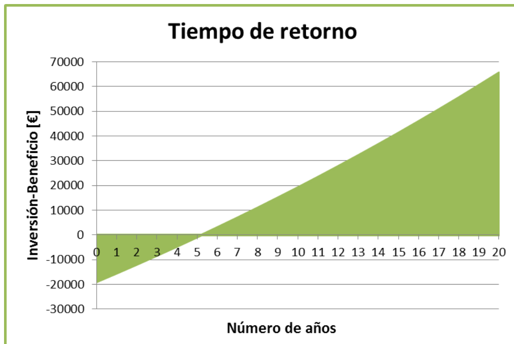
Figura 6.4: Tiempo de retorno de la inversión total teniendo en cuenta reparaciones y averías.
