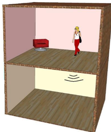
Figura 3.2 Generación y transmisión de ruido de impacto [7].
