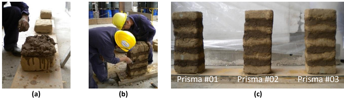
Figura 2. Preparación de los prismas para la caracterización mecánica: (a) colocación del mortero, (b) construcción de prisma de adobe y (c) aspecto de los prismas antes del ensayo.
