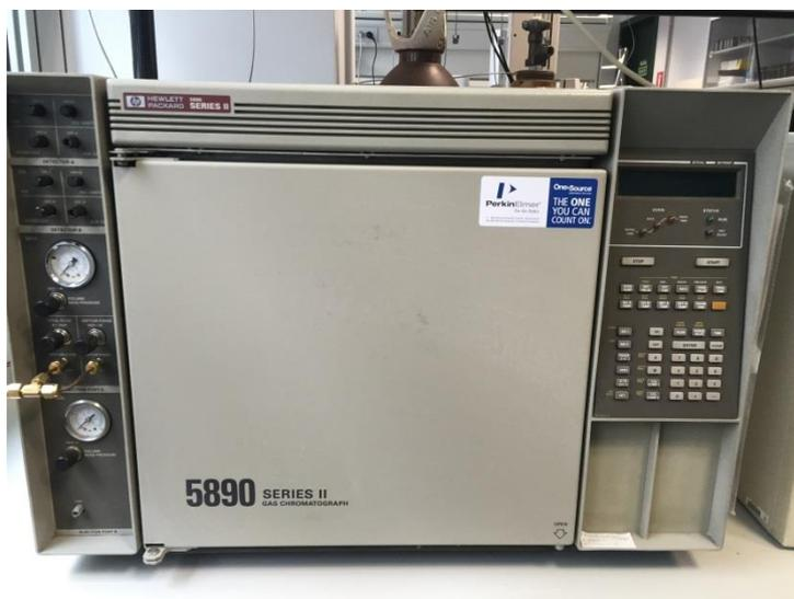
Figura 3.8. Cromatógrafo de gases 5890 Series II Hewlett-Packard con inyector *on-column*.
