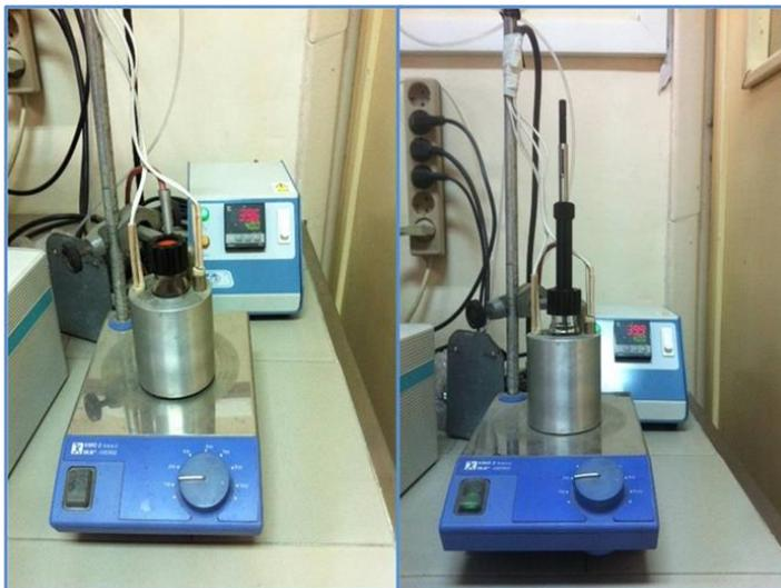
Figura 3.3. Dispositivo de espacio de cabeza estático para preconcentración manual de los compuestos volátiles con fibra SPME.
