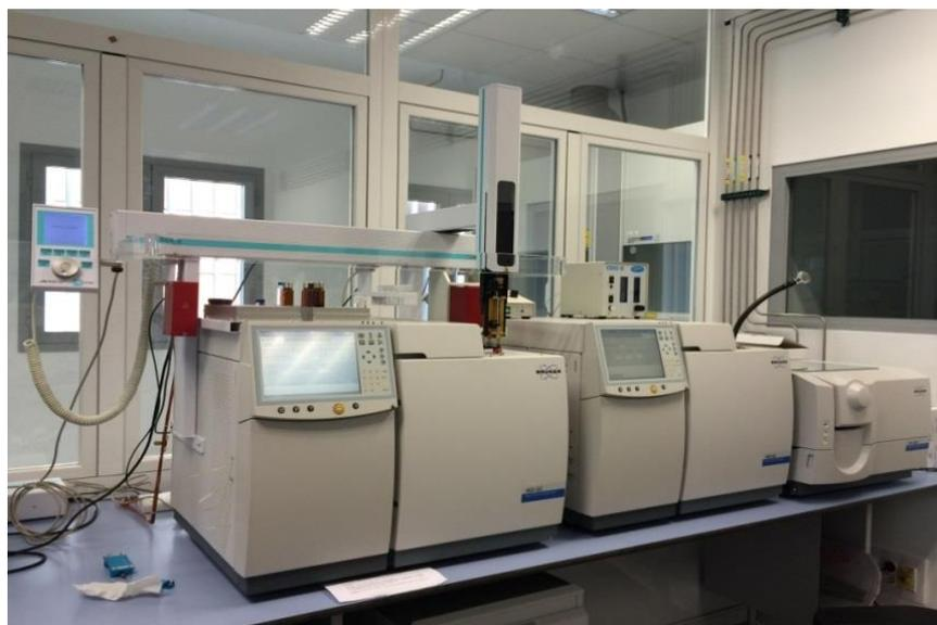
Figura 3.6. Cromatógrafo de gases bidimensional 450GC×450GC Bruker acoplado a espectrómetro de masas 300MS Bruker con inyector split-splitless adaptado para SPME y muestreador automático CombiPal.
