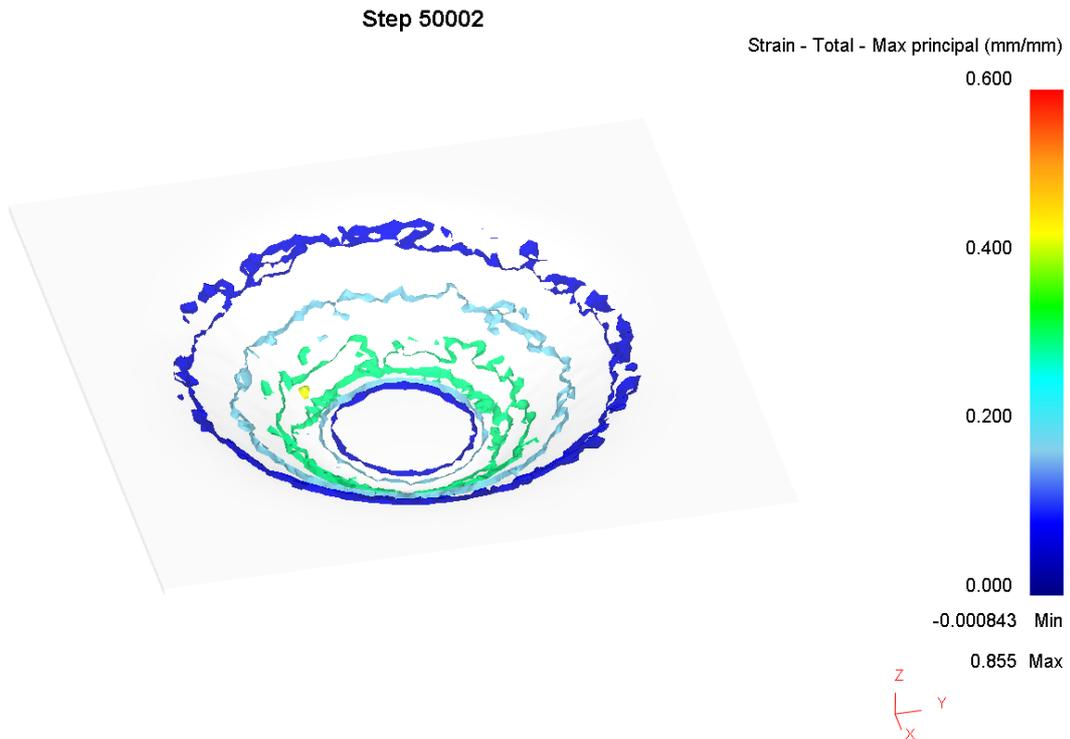
Figura 3.20 Superficies isodeformadas de la deformación principal  $\epsilon_1$  para una placa deformada por un punzón de 10 mm de diámetro en una placa de AA2024-T3 conformada por SPIF
