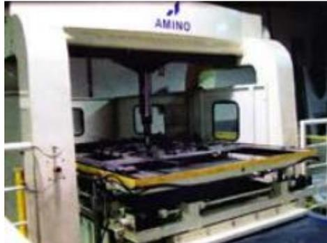
Figura 1.15 Máquina de conformado especialmente diseñada para el SPIF
