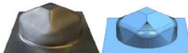
Figura 1.8 Geometría obtenida gracias al conformado multietapa
