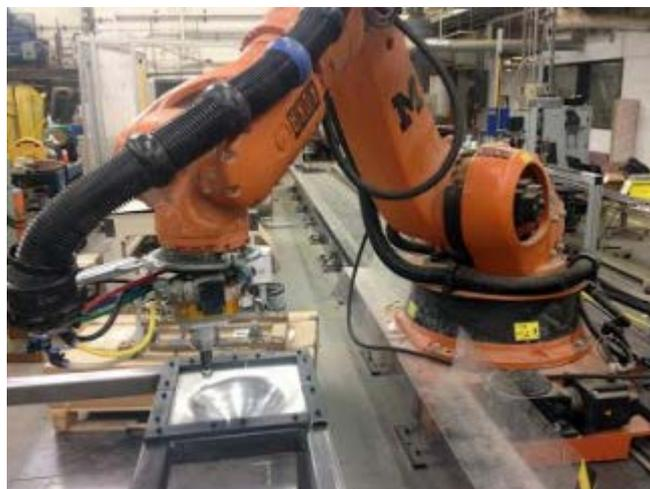
Figura 1.16 Brazo robot con el cual es posible conformar mediante el SPIF
