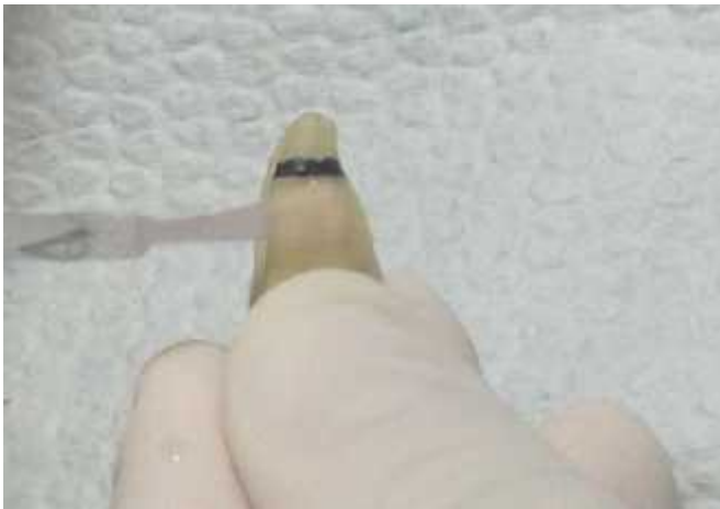
Fig. 14. Colocación del barniz de uñas excepto el tercio apical (3mm).
