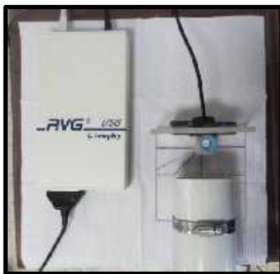
Fig. 2. Plataforma de acrílico para estandarizar la distancia y angulación de las radiografías.
