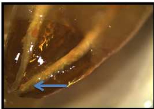
Fig. 34. Penetración de azul de metileno
