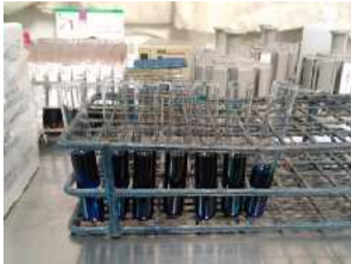
Fig. 16, Tubos de ensaye con colorante y las raíces antes del ciclo de centrifugado.
