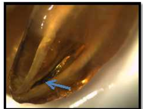
Fig.35. Penetración de azul de metileno
