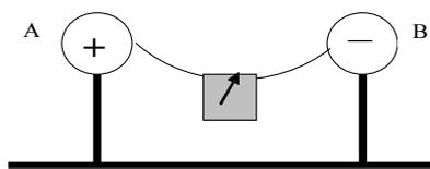
4. En una feria de la ciencia, los divulgadores muestran a unos visitantes la siguiente experiencia (Figura 1): Se toma un cuerpo A, cargado positivamente, y otro cuerpo B, cargado negativamente; a continuación, se unen mediante un hilo conductor, que lleva conectado un amperímetro para observar si hay o no paso de corriente eléctrica. Lo que se
