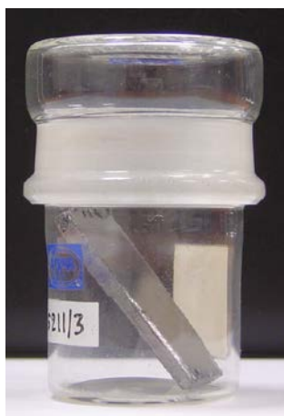
Fig. 4.1. Pesasustancias de vidrio pyrex empleado para preparar una muestra con el grafito en su interior.
