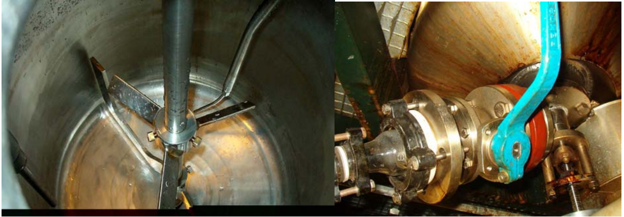
Figura III.64. Detalles del interior del reactor R-3 (tubo buzo y sistema de agitación) (izquierda) y de la salida del reactor (válvula de bola) (derecha)
