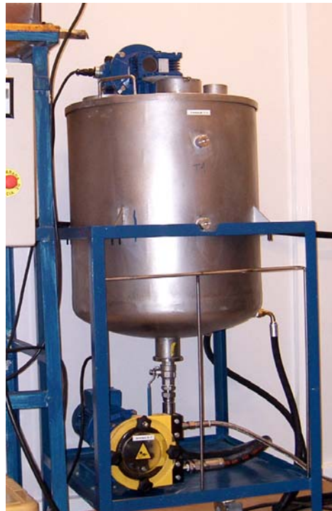
Figura III.80. Reactor de lixiviación
