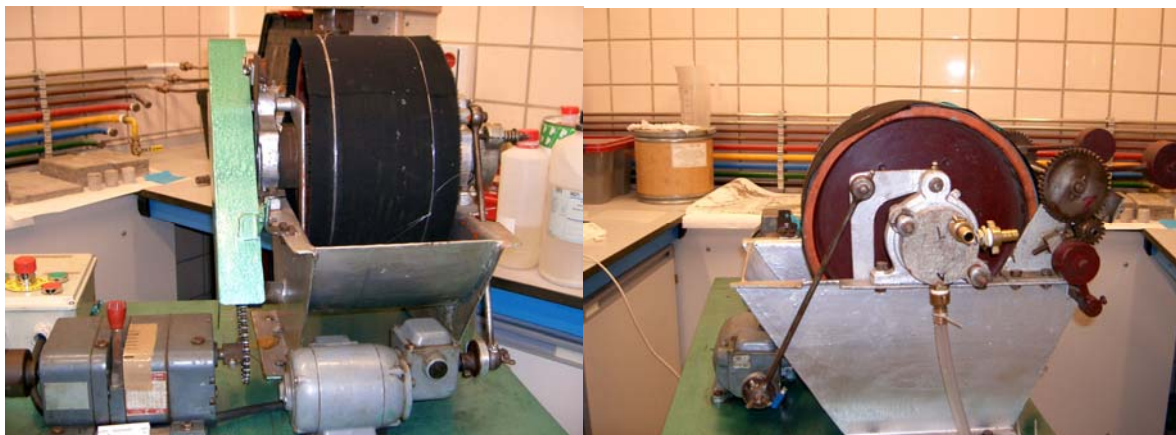
Figura III.83. Vista general del filtro rotatorio (izquierda) y conexiones del filtro (derecha)
