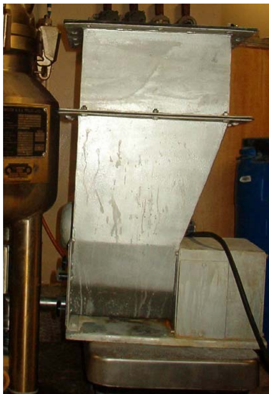
Figura III.69. Sistema dosificador de sólidos
