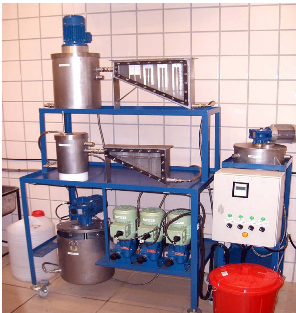
Figura III.88. Vista general del sistema de extracción líquido-líquido, campana extractora y tanque de descarga de la solución concentrada
