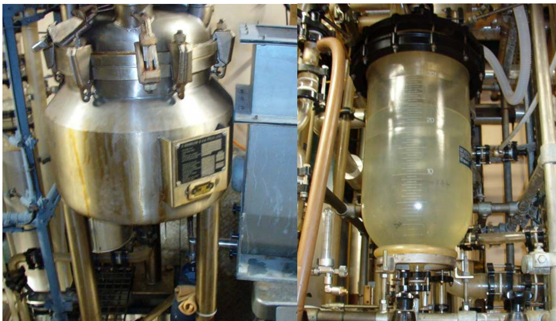
Figura III.62. Reactor de precalentamiento del agua (R-1) (izquierda) y reactor de dosificación del agua de entrada al reactor (R-2) (derecha)
