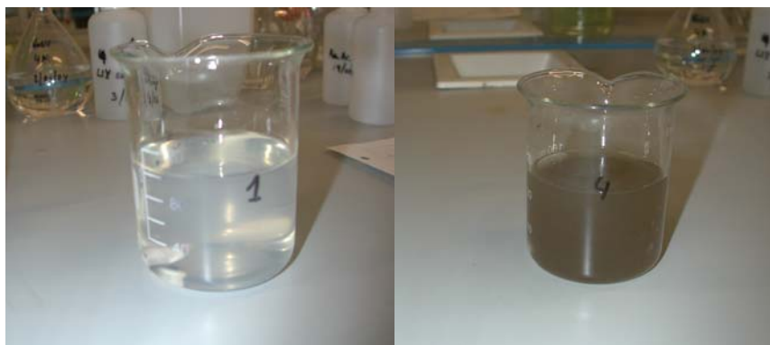
Figura III.47. Detalle de la solución 1 (proporción CAT/Ge = 1,94) (izquierda) y de la solución 4 (proporción CAT/Ge = 5,72) (derecha)
