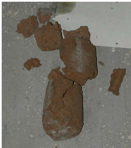
Figura 7.18 Mortero con cenizas carbonatadas después del ensayo de resistencia al fuego
