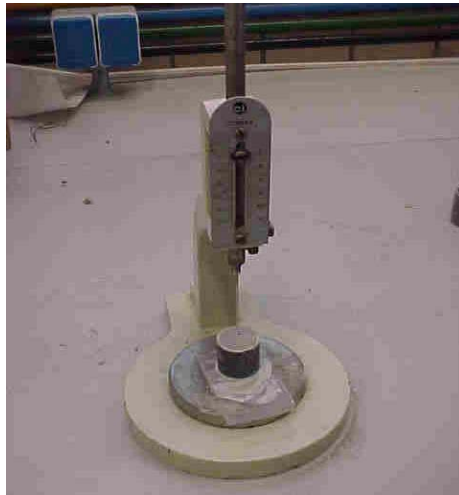
Figura 6.2 Aparato de Vicat para determinar la consistencia normal y el tiempo de fraguado de pastas
