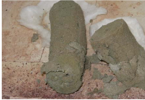
Figura 7.22. Fotografía del cilindro con cenizas APC, tras el ensayo de resistencia al fuego
