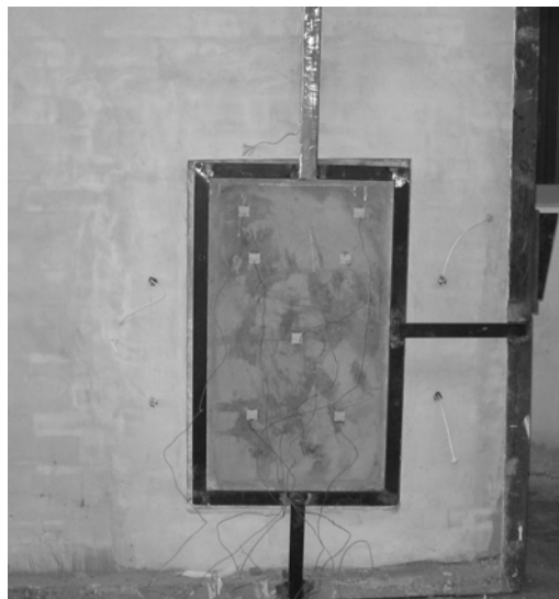
Figura 6.10 Distribución de los termopares en la cara no expuesta de la placa
