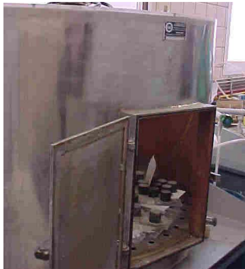
Figura 6.3 Cámara húmeda usada para el fraguado de las muestras
