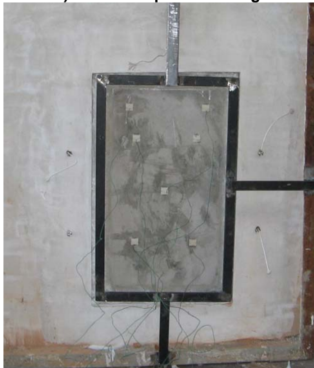
Figura 7.58 Fotografías de las caras expuesta (A) y no expuesta (B) de la placa tras el ensayo de resistencia al fuego
