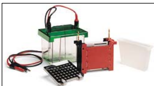
Figura 3.3. Equipo necesario para la realización de la técnica de Western Blotting .
