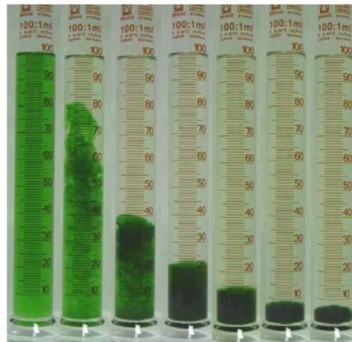
Figura 43. Sedimentación de biomasa de Anabaena procedente de RPV. De izquierda a derecha los tiempos de sedimentación son: 0, 5, 10, 15, 20, 25, y 30 minutos. Concentración de biomasa 0,5 \text{ g l}^{-1} .
