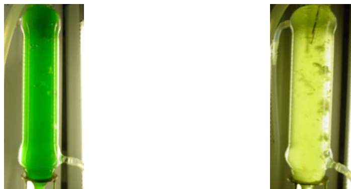
Figura 17. Fotoquimiostatos con cultivos de Anabaena en régimen continuo, mantenidos a 35 °C (izquierda) ó 45 °C (derecha). Condiciones experimentales como en Fig. 16.
