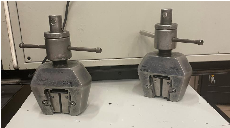
Figura 6.2 Mordazas para poder realizar el ensayo de fuerza
