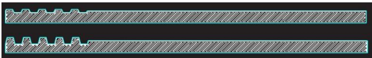
Figura 6.10 Probetas con interfase estructurada simétrica de 1 mm y 2 mm de amplitud respectivamente
