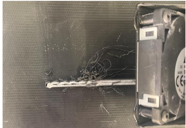
Figura 5.9 Imperfecciones generadas en la zona de solape de una probeta estructurada
