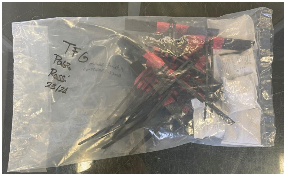
Figura 6.5 Probetas guardadas herméticamente durante el proceso de curado
