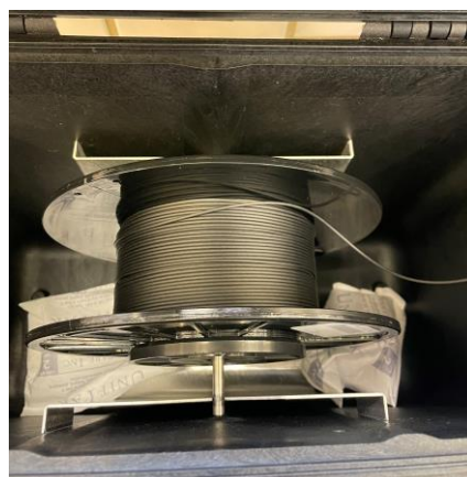
Figura 4.3 Onyx dentro de la caja de sellado
