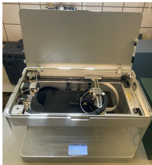
Figura 4.1 Impresora Mark Two fabricando una probeta estructurada
