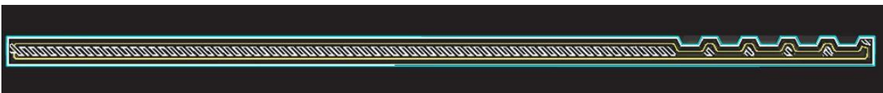
Figura 5.12 Simulación 2D impresión de la fibra en una de las capas de la impresora obtenida en el menú XRAY
