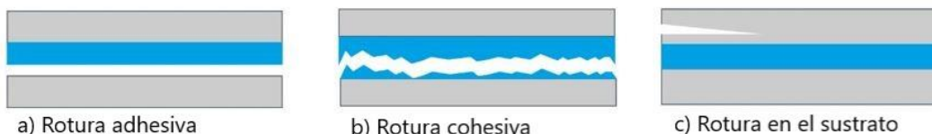
Figura 2.5 Diferentes tipos de rotura adhesiva [18]
