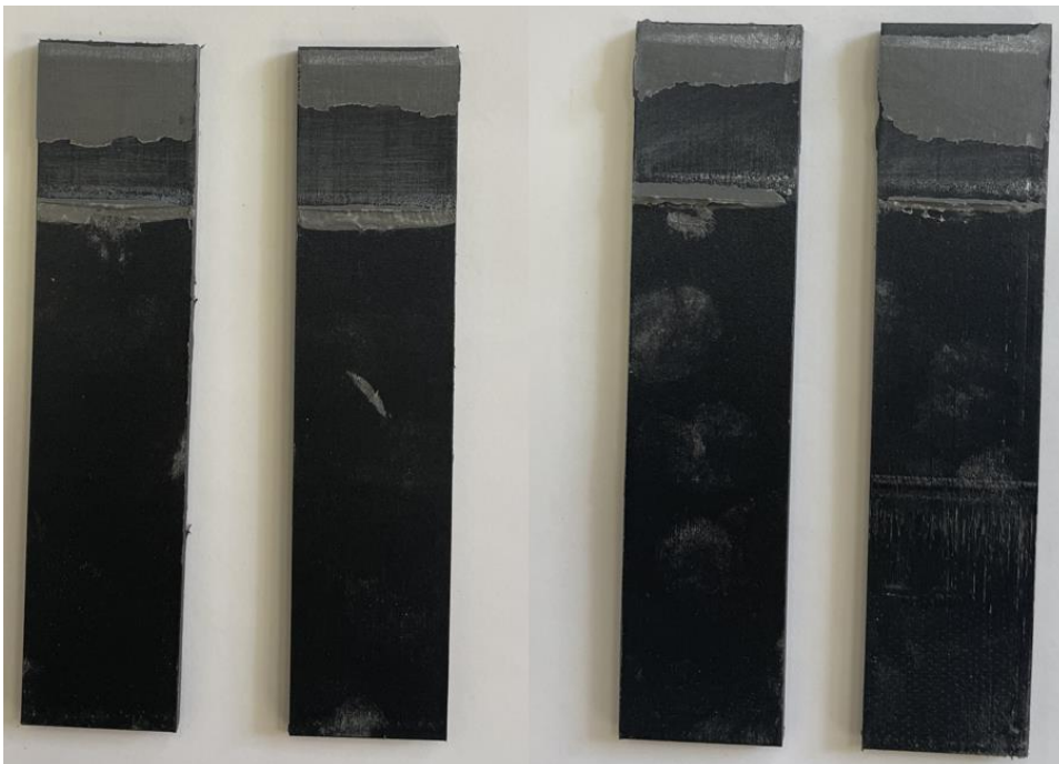
Figura 6.18 Solape de probetas planas después de someterlas al ensayo de cortadura
