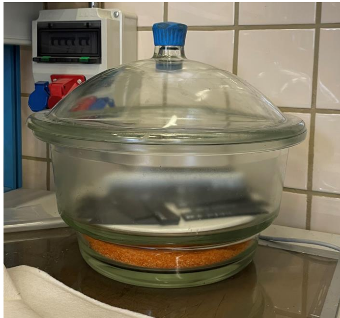
Figura 5.14 Campana para proteger a las probetas de la humedad
