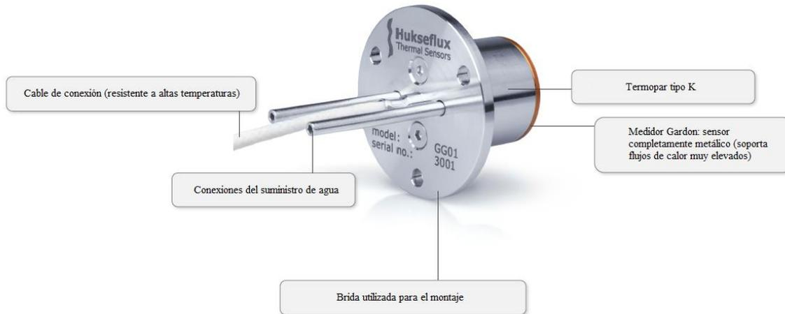
Figura 94. Esquema explicativo de los componentes del sensor GG01 Gardon gauge [47]
