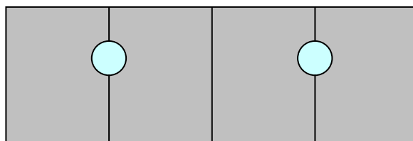
Figura 3.10. Esquema de un forjado con conductos embebidos. Sección por un plano perpendicular a los conductos.
