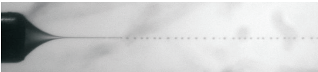
Figura 1.3: Configuración de coflujo operando en el régimen de narrowing.
