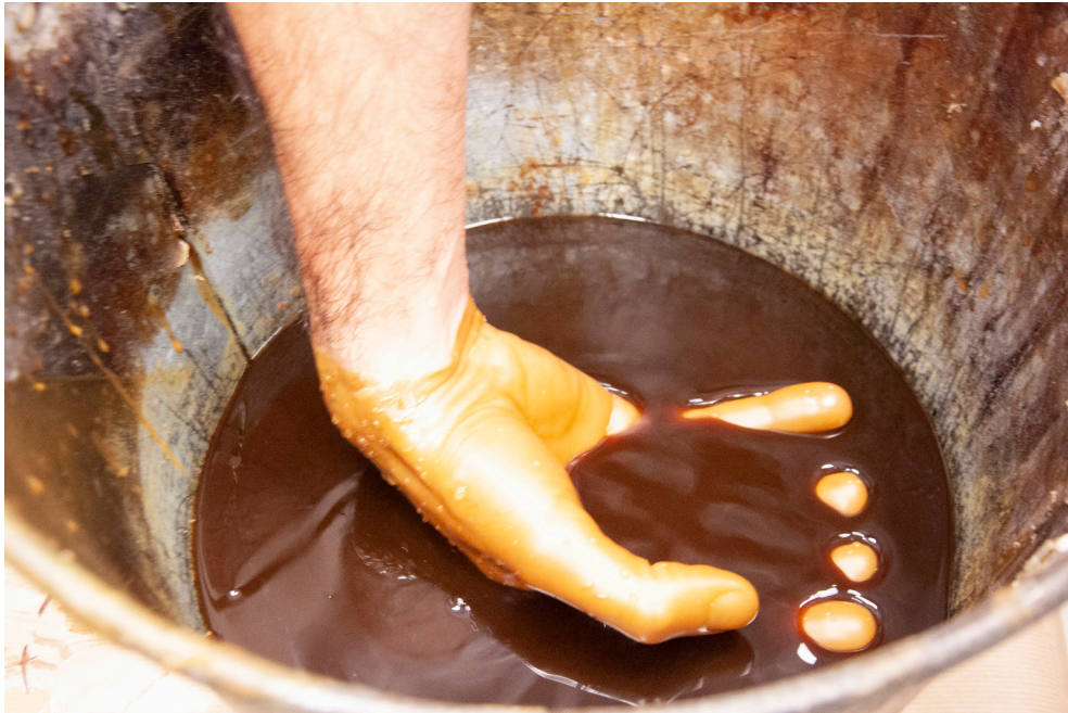
Figura 2. Construcción del molde de cera por inmersión de una mano
