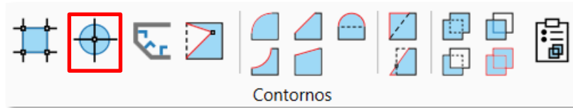
Ilustración 5-11. Comando de Contorno Circular. (Fuente: Elab. Propia).
