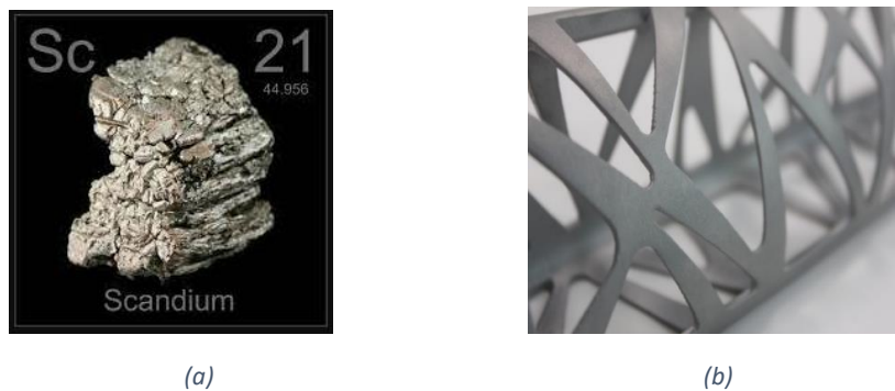
Figura 2. a) Mineral escandio, b) material Scalmalloy [5].
