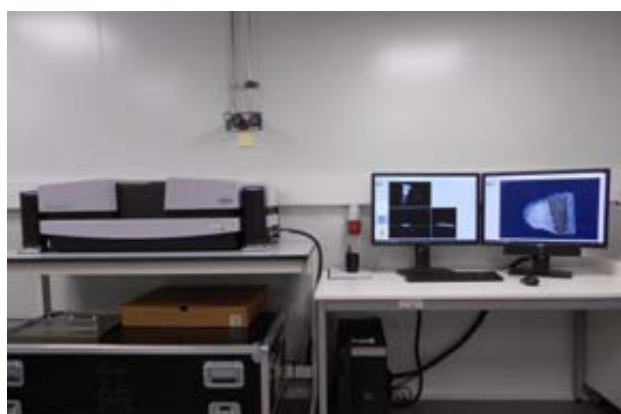
Figura 6 - Microtomógrafo Skyscan 1272 (Bruker) utilizado en el estudio
