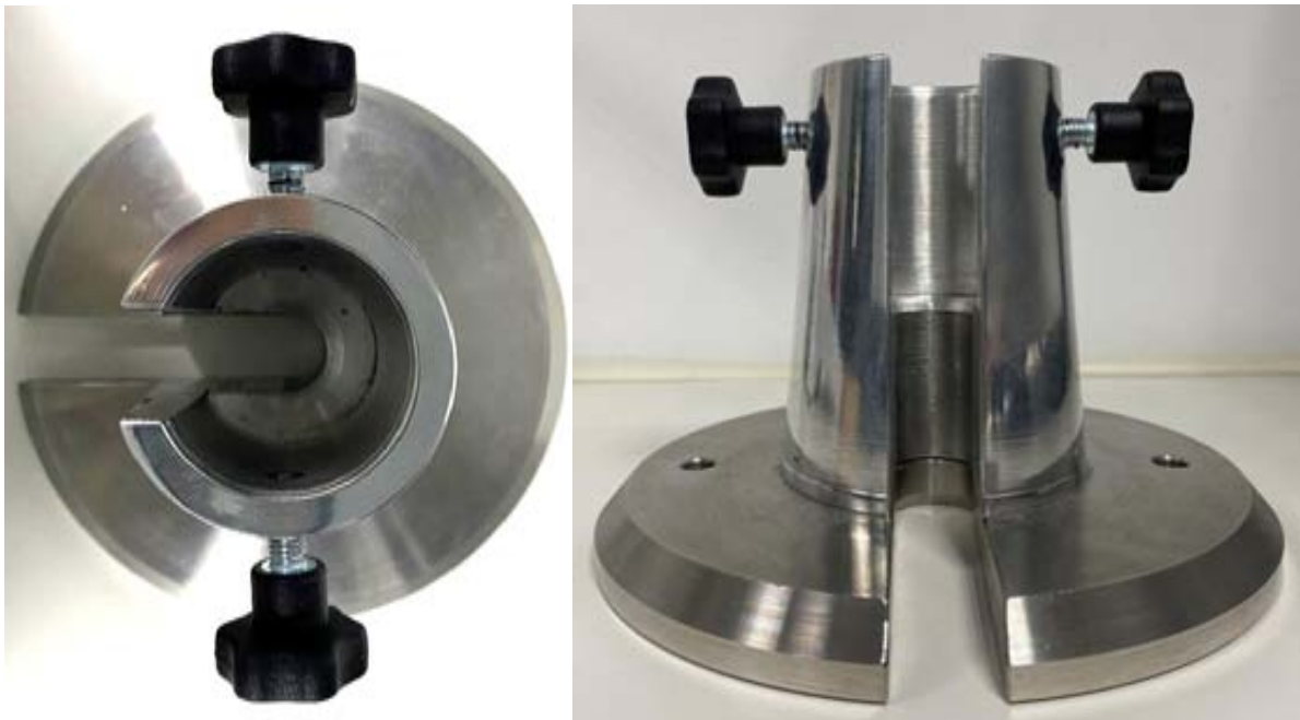
Figura 38 – Soporte metálico para fijación del mandril
