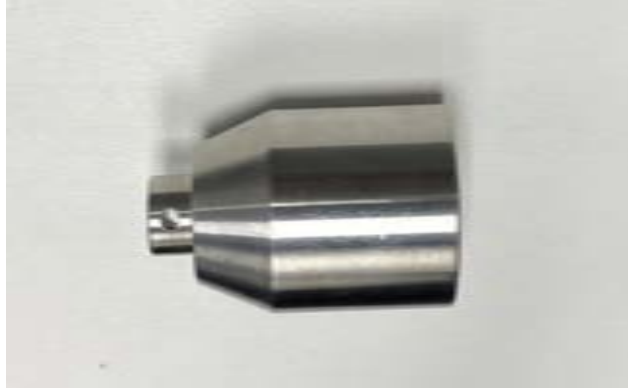
Figura 50 - Soporte de carga para atornillar a la parte final del pistón
