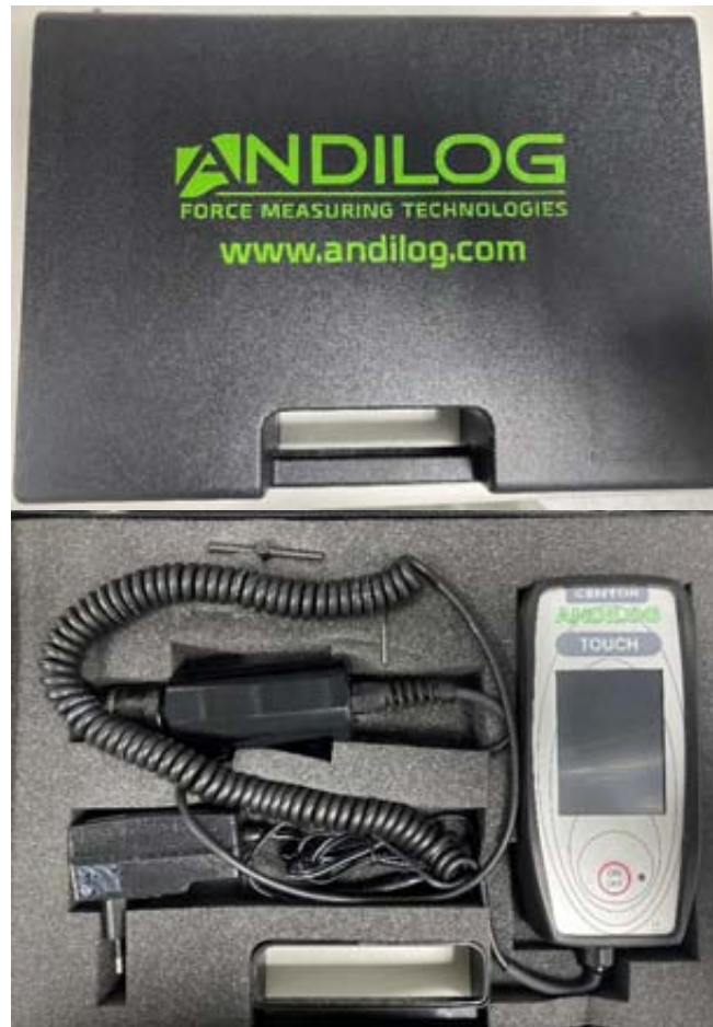
Figura 13 – Medidor de Torque Digital Centor Touch Star TH ®
