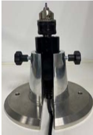
Figura 39 – Mandril en el soporte metálico y la ranura por donde pasa lo cabo evitando así interferencias en lo estudio.
