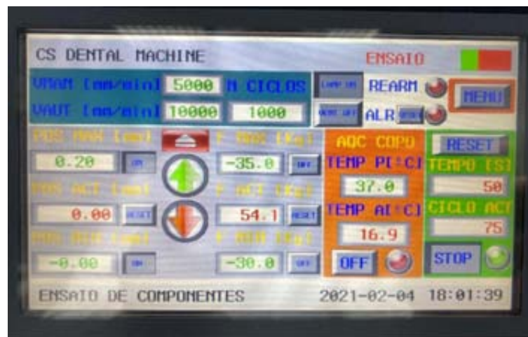
Figura 42 – Vista del LCD de la máquina de fatiga durante un ensayo
