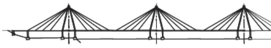
Fig 2.3. Metodología recomendada de rigidización longitudinal 3
