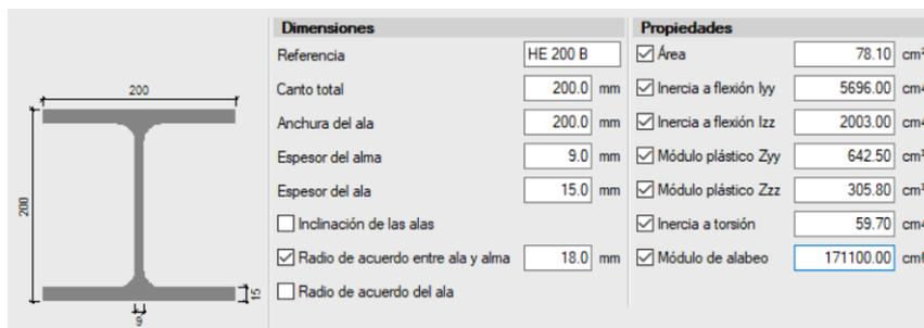
Figura 3.20 Perfil pilar de acero HEB 200.
