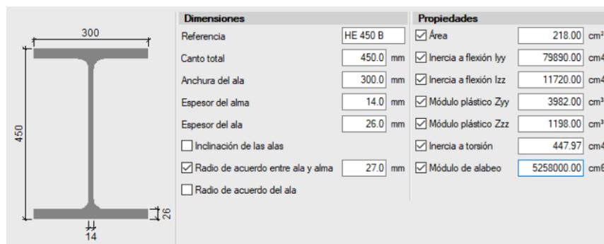
Figura 3.26 Perfil pilar de acero HEB 450.
