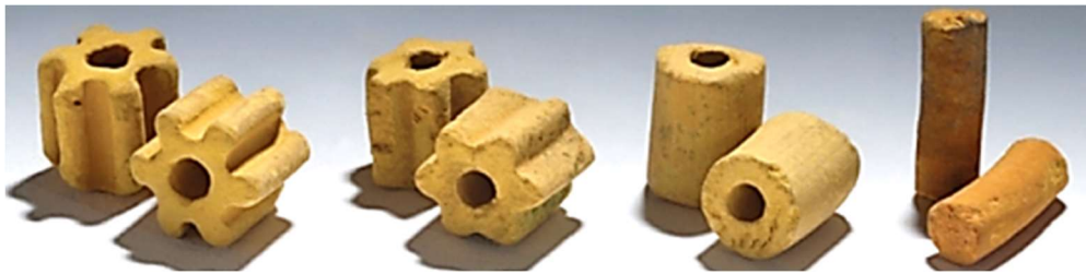
Figura 1-6. Tipos de los catalizadores típicos en la producción de ácido sulfúrico (R. Felthouse, P. DiGiovanni, R. Home, & A. Richardson, Fall/Winter 2011)
