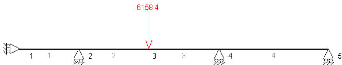
Figura 7.27. Esquema de carga sobre el eje primario 2 con la segunda velocidad engranada en el plano XY.
