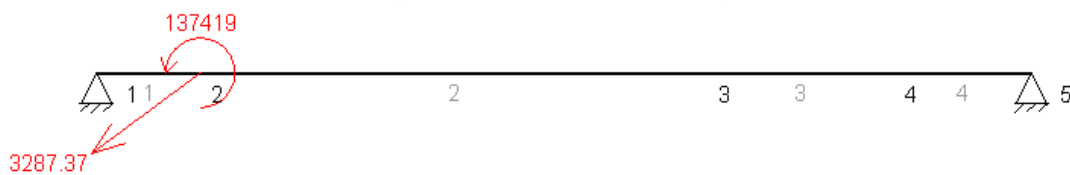
Figura 7.73. Esquema de cargas sobre el eje secundario 2 con la quinta velocidad engranada, en el plano XZ.
