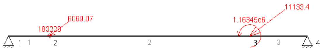
Figura 7.95. Esquema de cargas sobre el eje inversor con la marcha atrás engranada, en el plano XZ.
