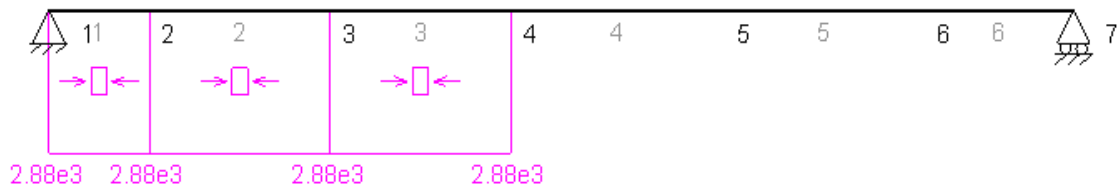
Figura 7.16. Diagrama de esfuerzos axiales sobre el eje primario 1 con la tercera velocidad engranada, en el plano XZ.
