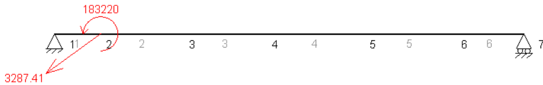
Figura 7.22. Esquema de cargas sobre el eje primario 1 con la quinta velocidad engranada, en el plano XZ.
