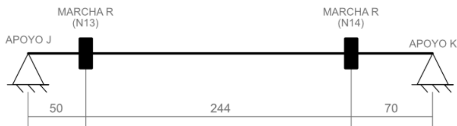
Figura 4.7: Esquema previo del eje inversor.
