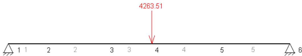
Figura 7.62. Esquema de carga sobre el eje secundario 1 con la cuarta velocidad engranada, en el plano XY.
