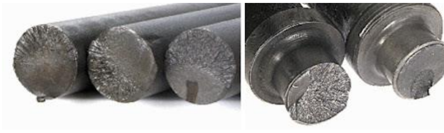
Figura 7.99. Fractura por fatiga de ejes.
