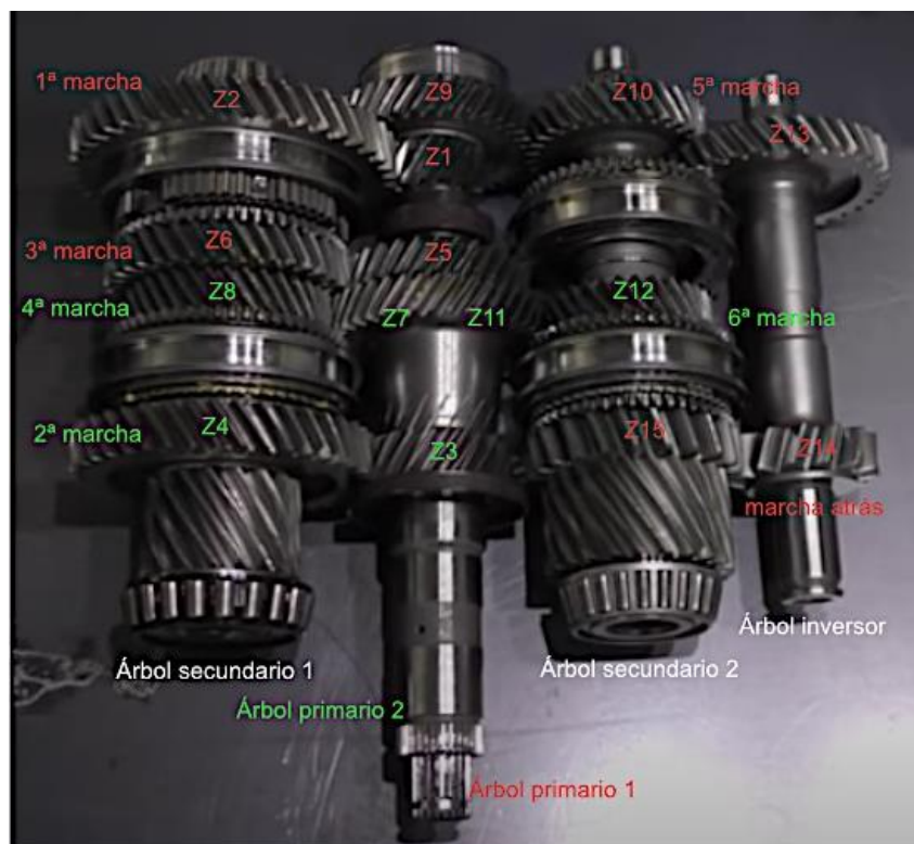
Figura 5.10: Disposición de los engranajes y enumeración. DSG 6V (02E)
