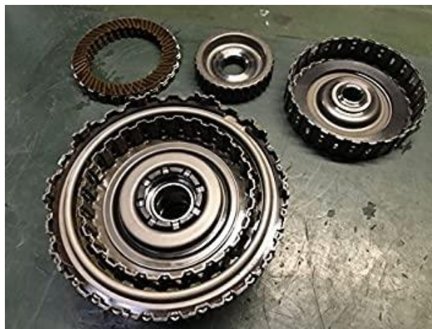
Figura 3.5: discos, embrague K2, embrague K1, conjunto abierto (corona exterior e interior).
