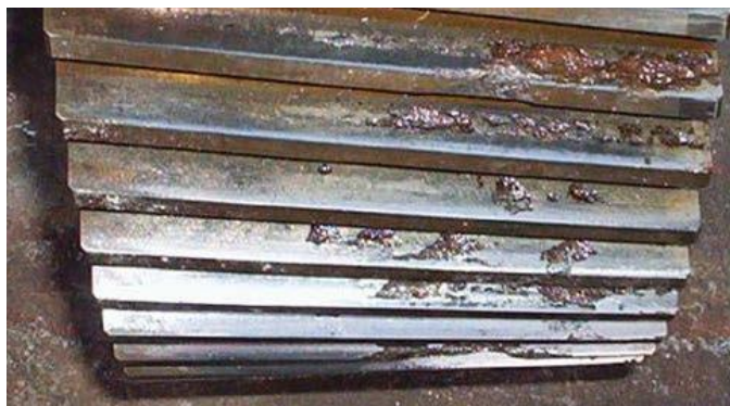
Figura 6.1. Falla por picadura en el flanco del diente.
