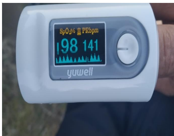
Figura B 6. Nota. Pulsioxímetro, para el control de la SatO 2 y la FC.
